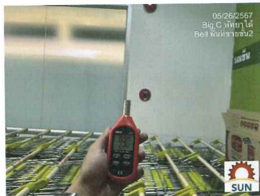
รูปที่ 2.71 ทดสอบ Alarm Bell พื้นที่บริเวณห้างสรรพสินค้า และ วัดค่าเสียงได้ที่ 93
