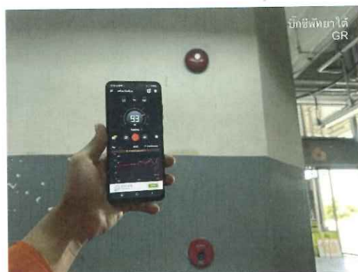
รูปที่ 2.68 ทดสอบ Alarm Bell พื้นที่บริเวณหน้าห้อง GR และ วัดค่าเสียงได้ที่ 93
