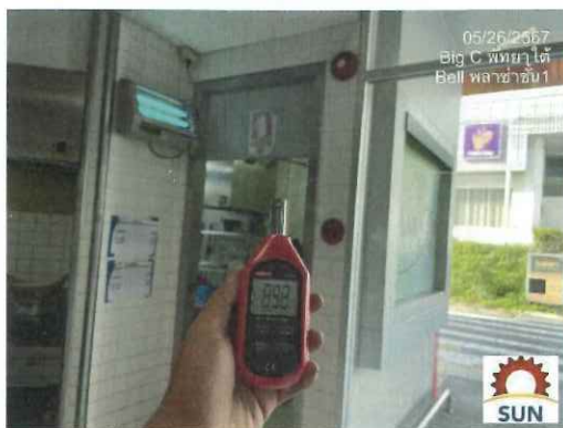
รูปที่ 2.76 ทดสอบ Alarm Bell พื้นที่บริเวณห้องครัวแคนทีน และ วัดค่าเสียงได้ที่ 89.8
